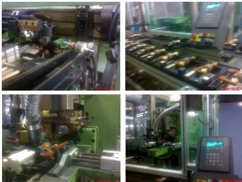
Gambar 4.10. Proses Penjepitan dan Pengelasan Wire dengan Commutator (O-6).
