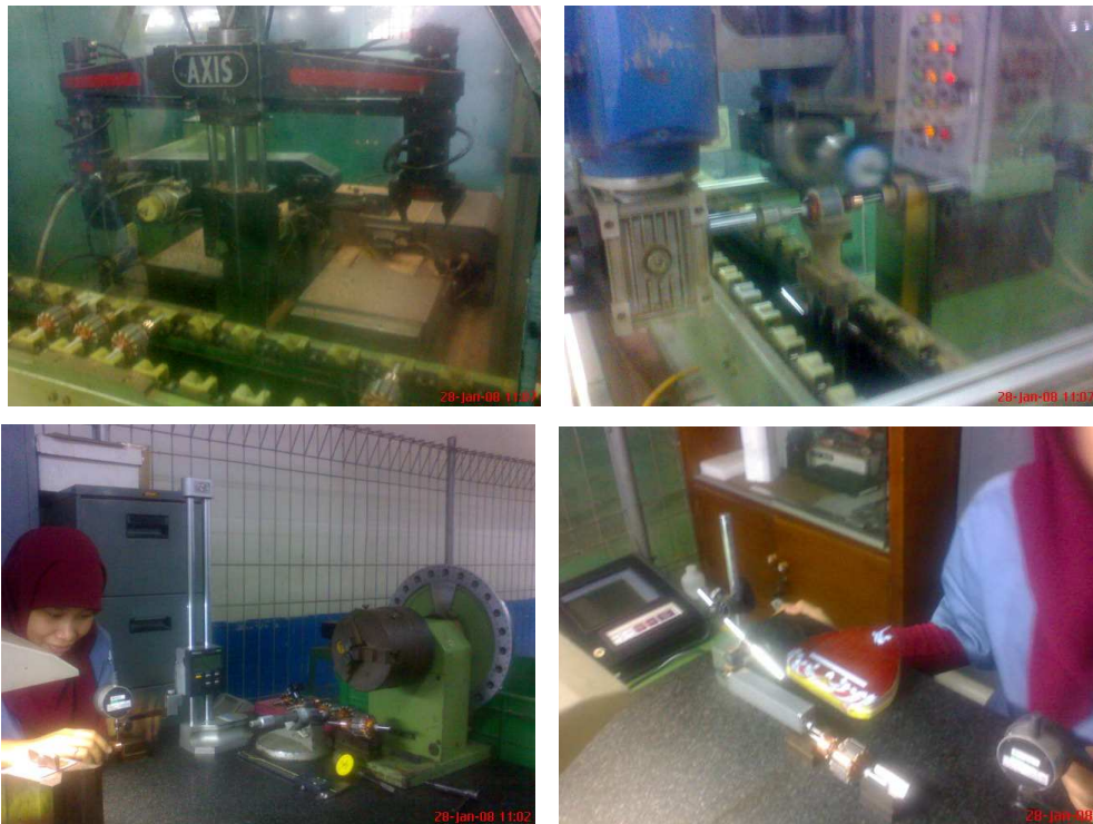
Gambar 4.12. Proses Pembubutan & Pengecekan Dimensi Commutator (O-8).
