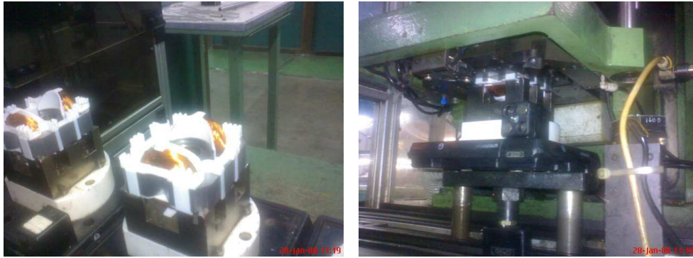
Gambar 4.17. Proses Pemasangan Terminal Stator (O-2).
