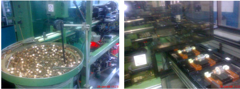
Gambar 4.8. Proses Pemasangan Comutator (O-4).
