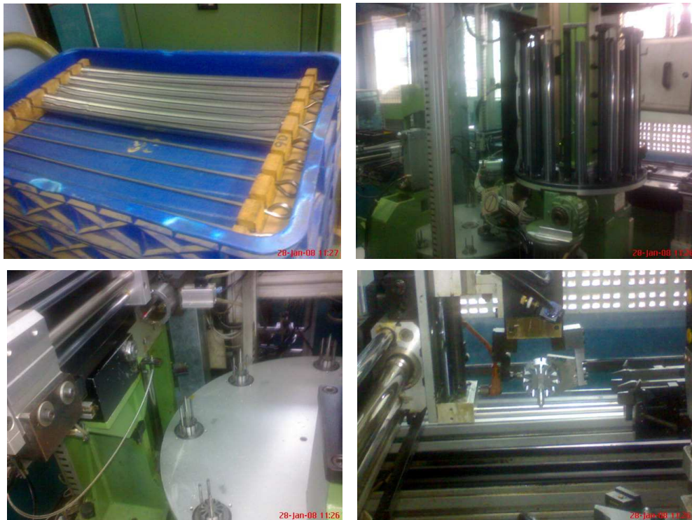
Gambar 4.5. Proses Perakitan Plat Laminasi dan shaft (O-1).
