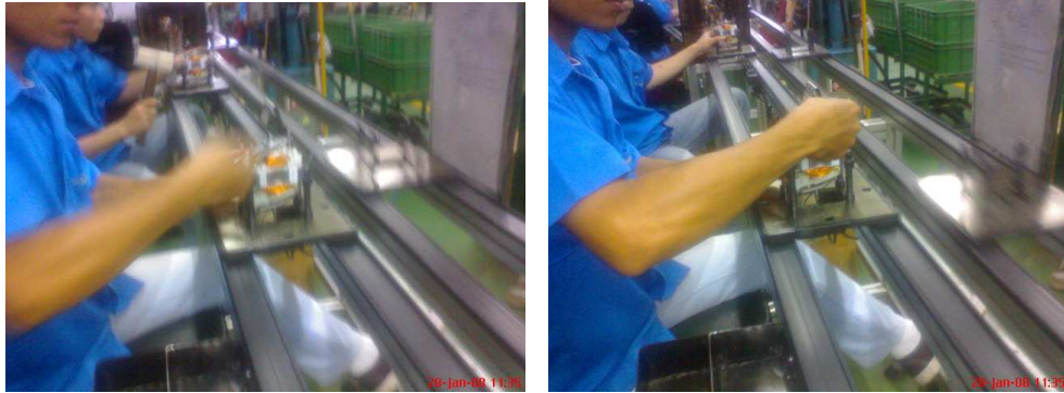
Gambar 4.26. Proses Pemasangan Bearing Unit ke Stator Pin (O-7).
