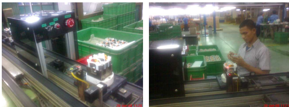
Gambar 4.19. Proses Pengetesan High Current (I-3) & Pemasangan Label (O-3).
