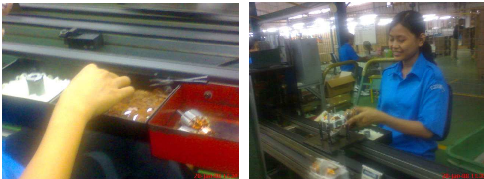
Gambar 4.25. Proses pemasangan rotor assy pada stator assy (O-5).
