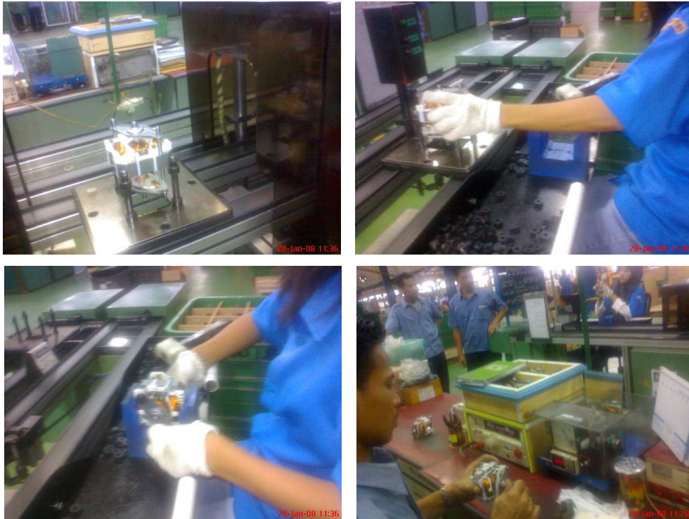
Gambar 4.27. Proses Pengecekan Fisik dan Fungsi Motor Assy.
