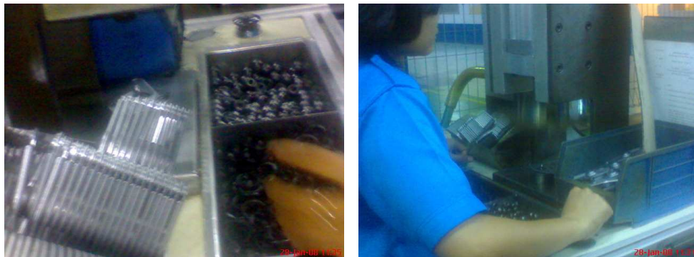
Gambar 4.23. Proses Perakitan Bearing Plate, Bearing, dan Bearing Clamp (O-3 dan O-6).
