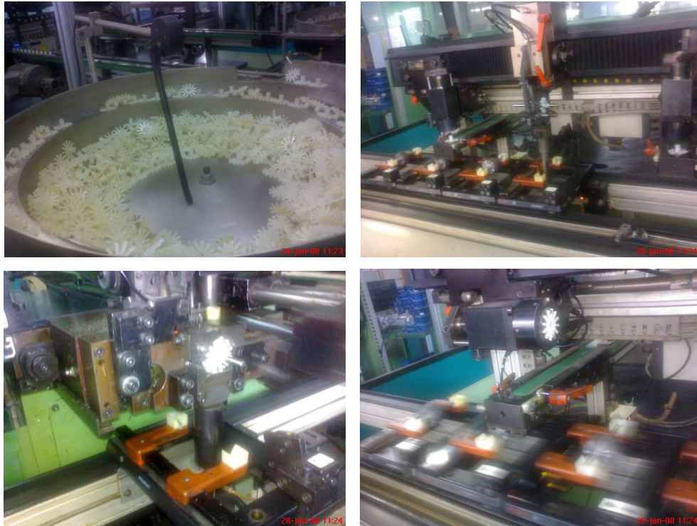
Gambar 4.6. Proses Pemasangan Rotor Disc (O-2).
