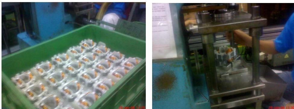
Gambar 4.21. Proses Pemasangan Stator Pin pada Stator Assy (O-1).
