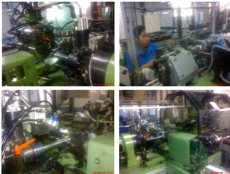
Gambar 4.9. Proses Penggulangan Wire Rotor Manual & Otomatis (O-5).
